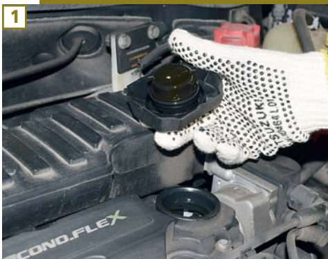
1) Remova a tampa de óleo do cabeçote do motor.
