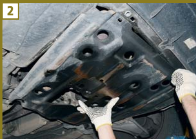
2) Com o carro no elevador, remova o protetor de cárter. Neste caso, observe como o protetor está “melado” de óleo, denunciando vazamento em algum ponto do motor.
